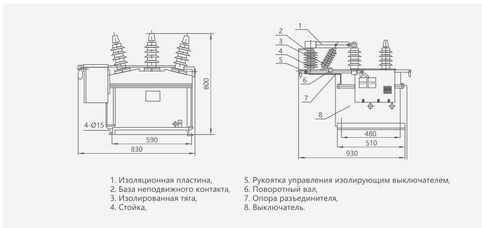
Рисунок 2. Габаритные и монтажные размеры ZW8-12G/T
